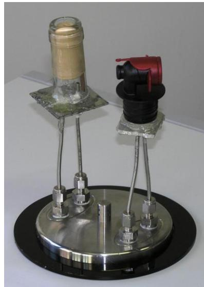
PackPerm è conforme alle norme DIN 53380-3 e ASTM F1307 per la misura di O<sub>2</sub>TR attraverso confezioni asciutte.
