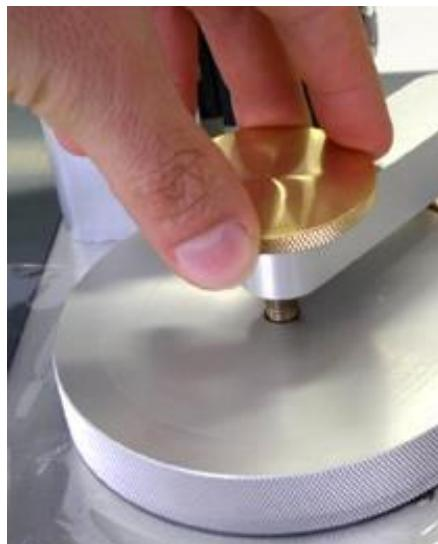
PermeO<sub>2</sub> è conforme alle norme DIN 53380-3, ASTM D3985, F2622, F1927, F1307, JIS K-7126 e ISO 15105-2 per la misura di O<sub>2</sub>TR attraverso film e materiali plastici.
