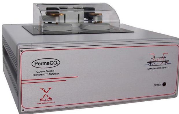
Misuratore di permeabilità all'anidride carbonica con controlli integrati di temperatura ed umidità relativa.
