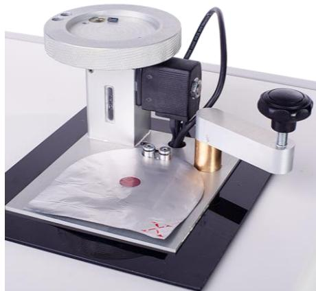
TotalPerm è conforme alle norme DIN 53380-3, ASTM D3985, F2622, F1927, F1307, JIS K-7126, ISO 15105-2 per la misura di O<sub>2</sub>TR, alla norma ASTM F2476 per le misure di CO<sub>2</sub>TR ed alle norme ASTM F1249, TAPPI T557, JIS K-1729, ISO 15106-2 per le misure di WVTR.
